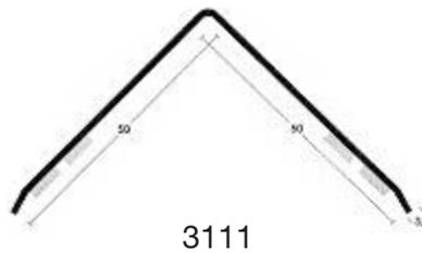
Die selbstklebenden Treppenkanten verfügen über ein schwarzes – 19 mm breites – rutschfestes, aufgeklebtes Band aus Karborundun.
